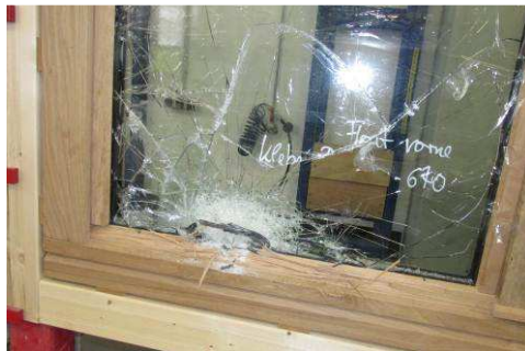
Bild 9 Schäden aus der manuellen Prüfung der Glasanbindung (VSG innen, Ramsauer 670)
