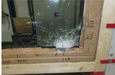
Bild 7 Schäden aus der manuellen Prüfung der Glasanbindung (VSG außen, Ramsauer 690)
