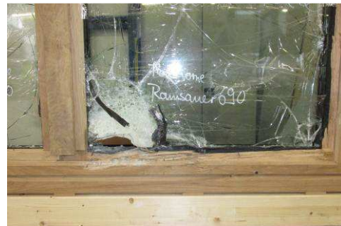
Bild 10 Schäden aus der manuellen Prüfung der Glasanbindung (VSG innen, Ramsauer 690)
